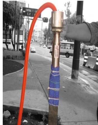
Figura No. 9 Piezo-Celda de cuerda Vibrante
