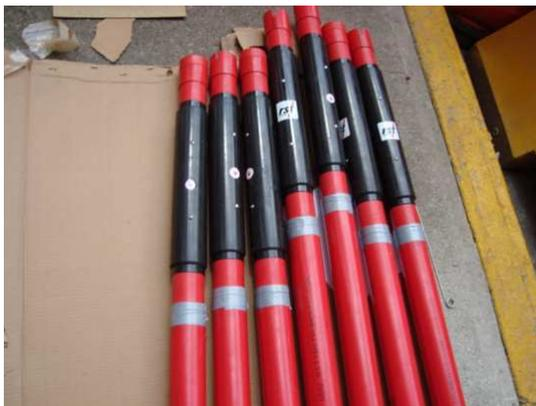
Figura No. 10 Tubería de inclinómetro con coples telescópicos
