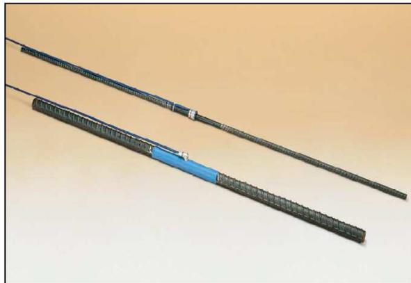
Figura No. 13 Deformímetro de acero
