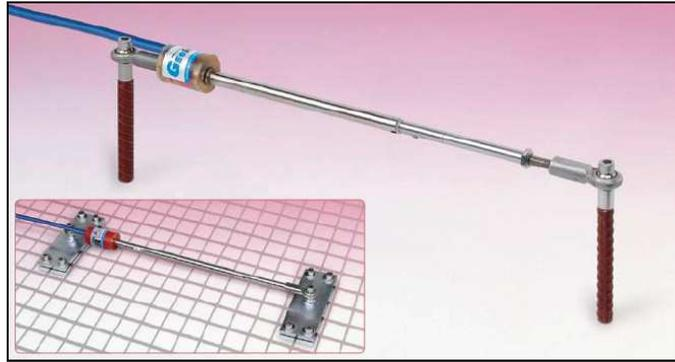
Figura No. 14 Medidor de juntas
