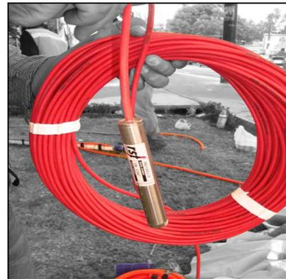
Figura No. 7 Piezómetro de cuerda Vibrante
