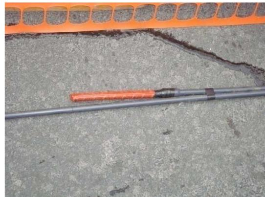
Figura No. 11 Extensómetro de barras
