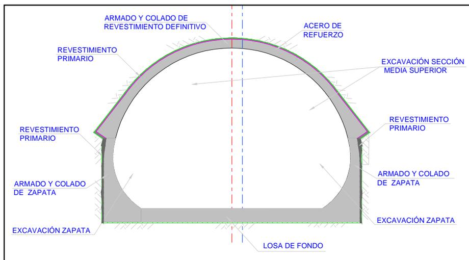
Figura No. 45 Sección de túnel terminada
