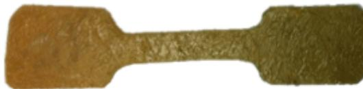
**Figura 115. Probeta de pericardio bovino 3**
