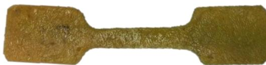
Figura 113. Probeta de pericardio bovino 1.
