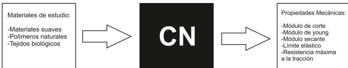
**Figura 12. Modelo de caja negra del Probador mecánico.**
