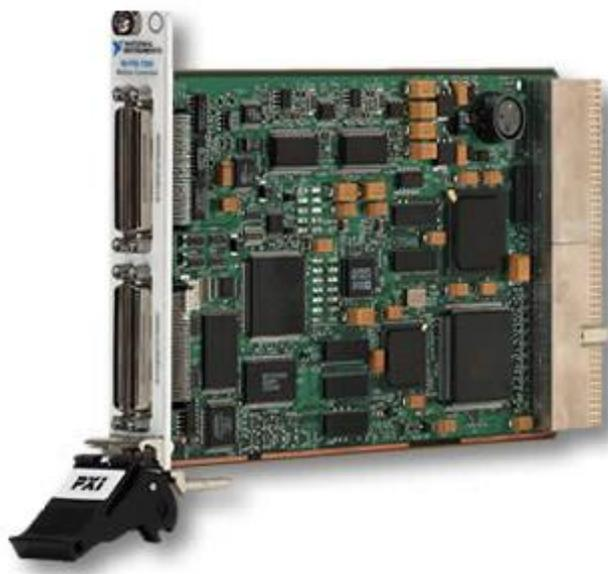
**Figura 67. Tarjeta NI-PXI7350 controlador de motores [40].**
