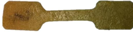
**Figura 114. Probeta de pericardio bovino 2**
