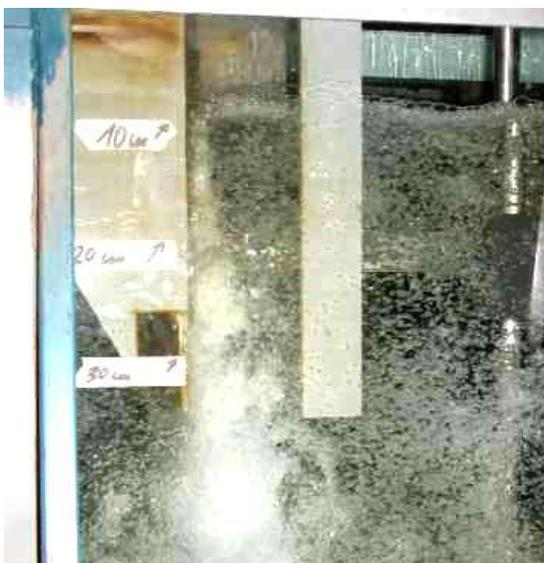
Fig. 2.5 Entrada de aire por chorro en soporte vertical causado por vórtices con ejes perpendiculares a la dirección del flujo, (Chanson, 2002).
