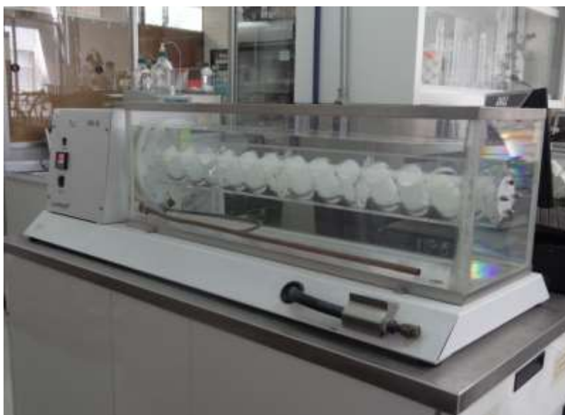
Figura 4. 9. Imagen fotográfica del dispositivo utilizado para la determinación de la bioaccesibilidad de As y Pb de acuerdo al Apéndice Normativo “C” de la NOM-147-SEMARNAT/SSA1-2004
