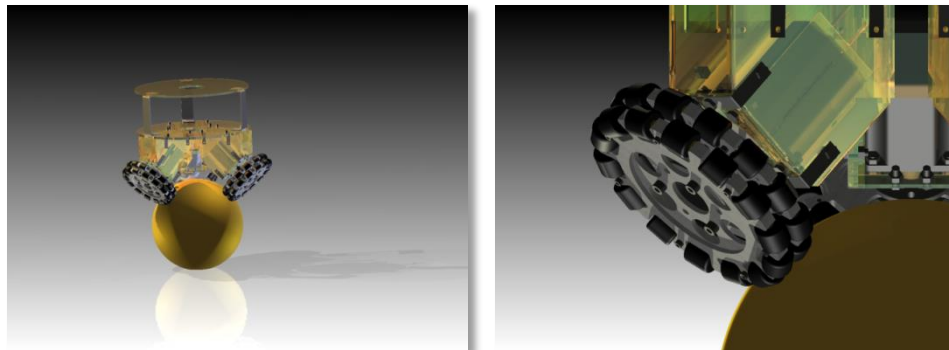
Figura 3.14 Ilustración del robot sobre la esfera y detalle del contacto con la esfera.
