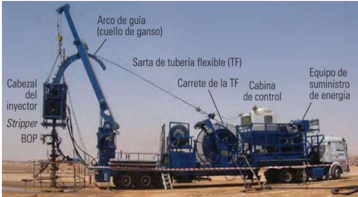
Equipo de perforación con Tubería Flexible
