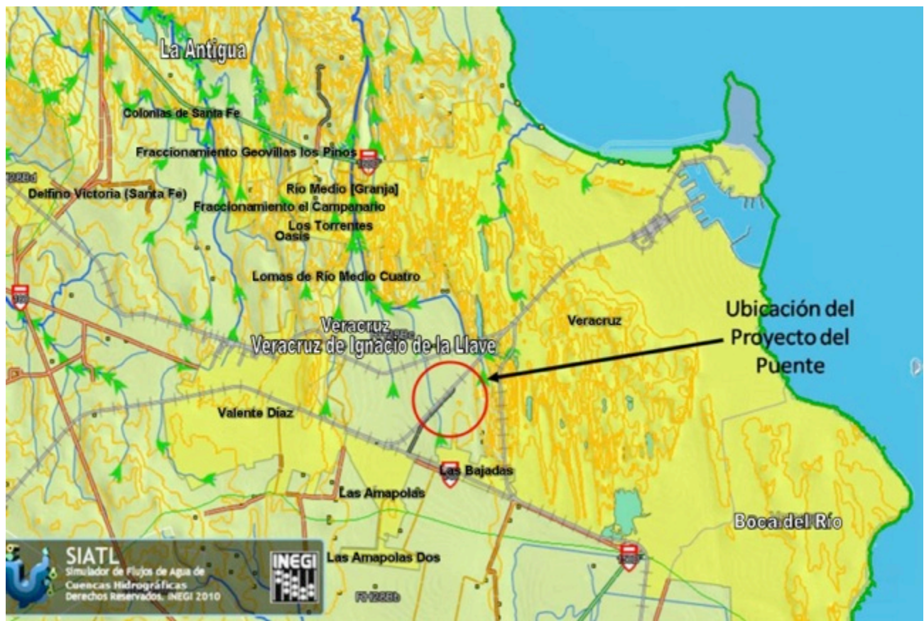
Mapa 3.2 Mapa con curvas de nivel de la ubicación del puente, se aprecia la escases de drenes en la zona del proyecto.
