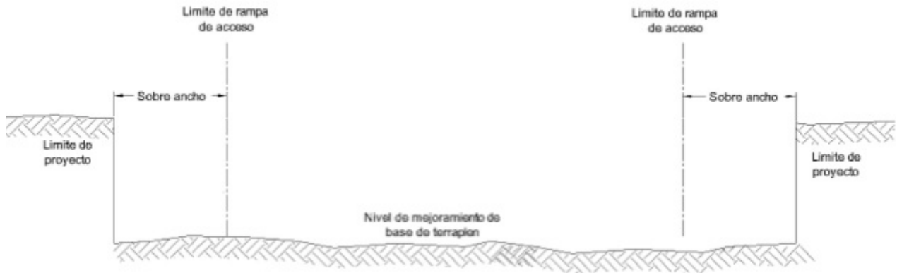
Figura 5.1 Preparación del terreno.
