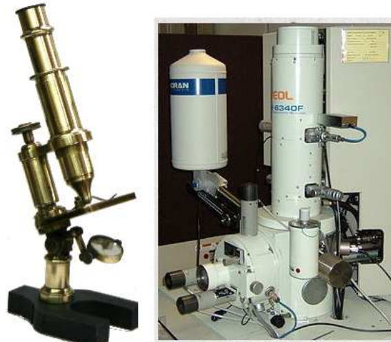
Figura 2.3 imagen izquierda: Microscopio Verick de Hartnack (1870), Imagen derecha: Microscopio Electrónico (época actual)
