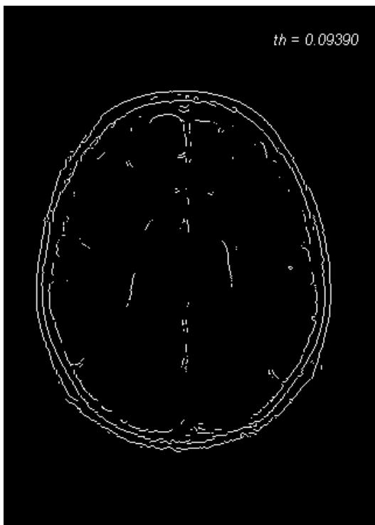
Fig. 3.5. Extracción de bordes utilizando operadores basados en la primera derivada. (a, b) Roberts, (c, d) Sobel, (e, f) Prewitt.
