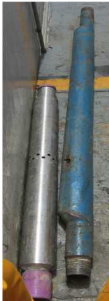
Figura 2.4 – Válvulas de circulación tipo camisa deslizante (izquierda) y tipo mandril (derecha)
