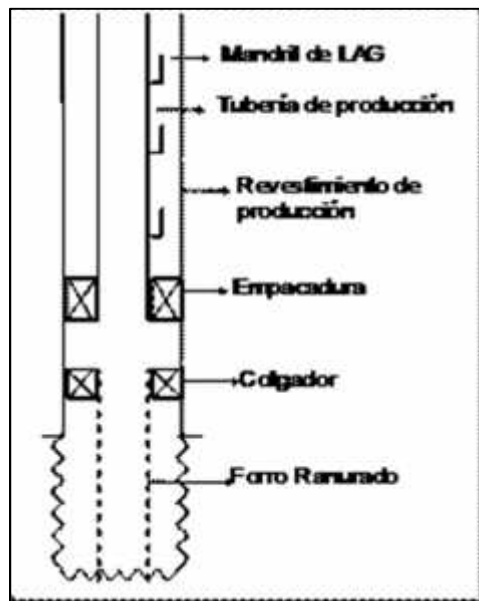
Figura 1.4 - terminación con tubería ranurada no cementada.
