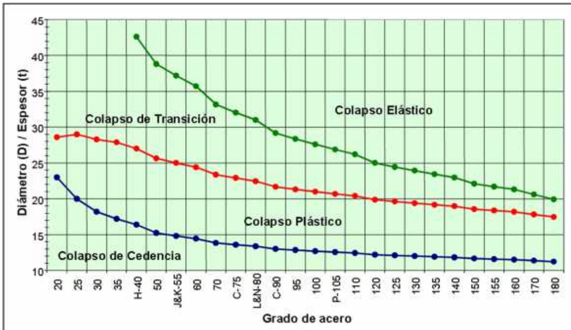
Figura 3.6 – Regiones de colapso según el grado de acero
