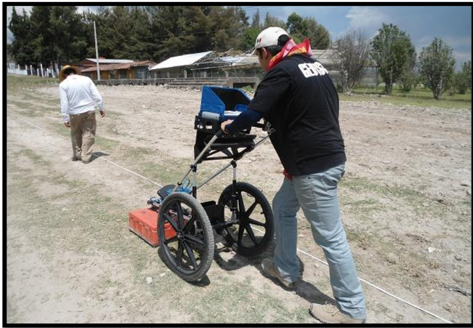
Fig.(4.5) Se muestra la adquisición de datos con el equipo de radar
