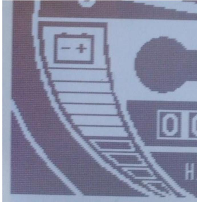
Figura 5.23. Display que muestra el estado de carga del banco de baterías.
