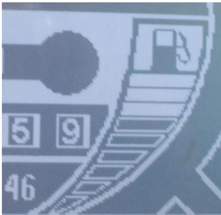
Figura 5.25. Display que muestra el nivel de gasolina en el tanque.
