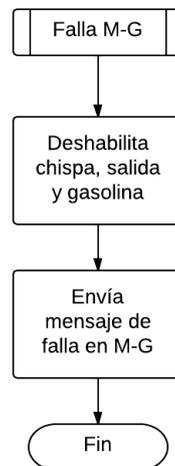
Figura 5.22. Diagrama de flujo de falla del moto-generator.
