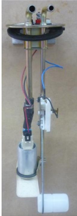
Figura 5.11. Flotador y bomba de gasolina.
