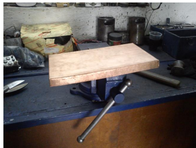
IMG. 3- PREFORMADO DE UN PRISMA RECTANGULAR
