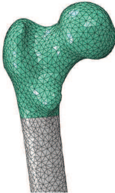
Figura 4.14 Cabeza femoral y parte de la diáfisis donde se aprecia la partición realizada y a la cual se le asignó hueso trabecular (verde agua).
