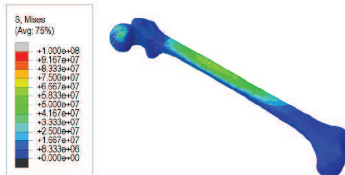
Figura 5.15 Estado de esfuerzos del modelo de fémur sometido a condiciones de sentadilla.
