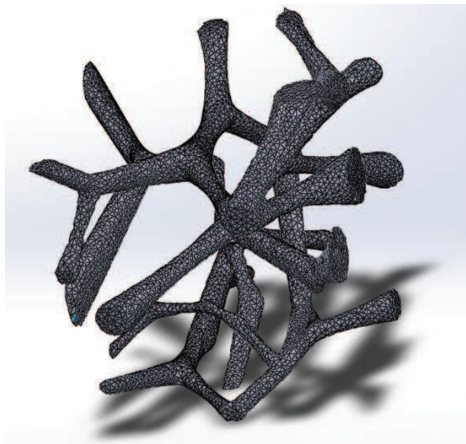
Figura A1.9 Modelo de hueso trabecular con errores de conectividad reparados.
