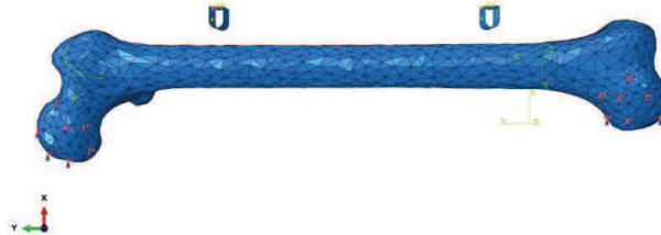
Figura 5.27 Condiciones de frontera del modelo de fémur sometido a flexión en cuatro puntos.
