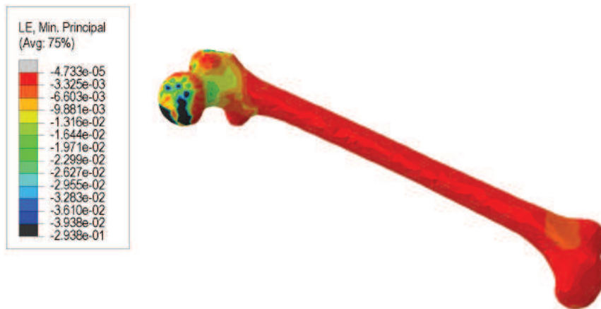
Figura 5.17 Deformaciones logarítmicas mínimas principales del modelo de fémur con condiciones de sentadilla.
