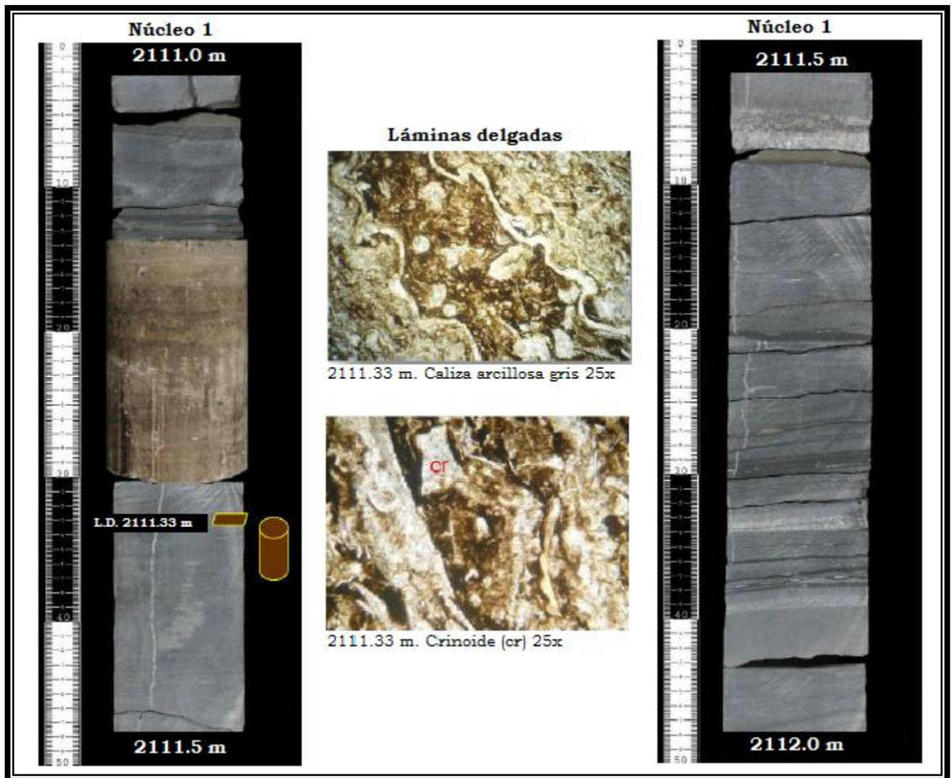
Figura 5.14 Núcleo 1 y láminas delgadas del intervalo 2111.0-2112.0 m. (PEMEX 2 , 2013).
