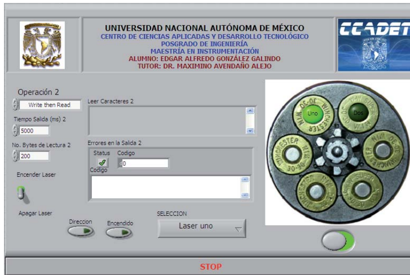
Figura 4.35: Panel frontal de control del revólver de diodos láser.
