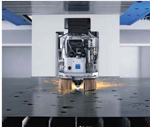
Figura 2.19: Un láser puede cortar hojas de acero con características y formas distintas
