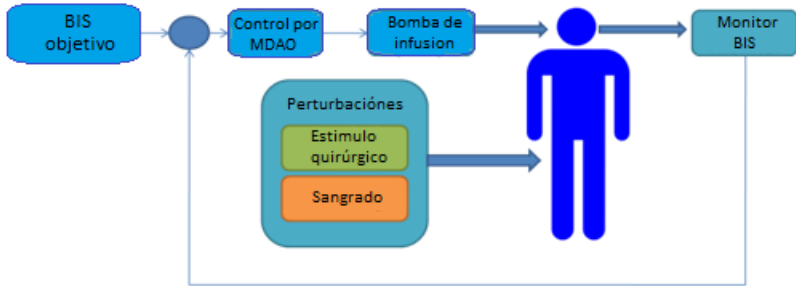
Figura 1.2: Diagrama de infusión de propofol de lazo cerrado.
