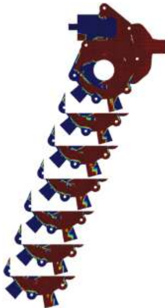
Imagen 2.2 Resultados del molde correspondiente al modelo tridimensional de la Imagen 2.1 obtenidos con el código de elementos finitos Wrafts® para distintas velocidades de inyección (López, 2011).
