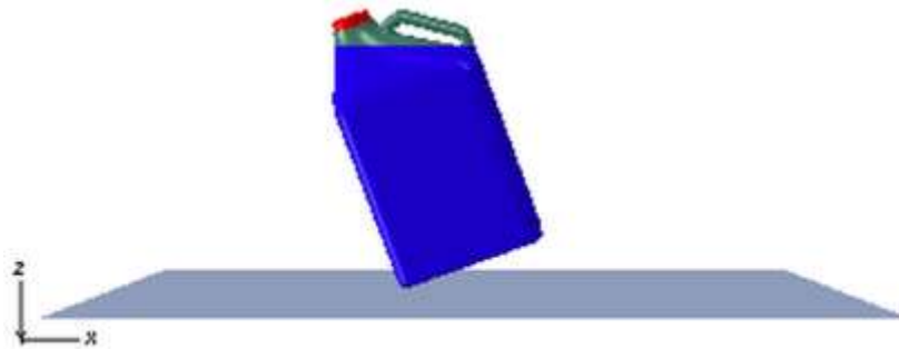
Imagen 2.14 Posición inicial para el análisis del impacto de la botella, se visualiza la botella en verde, el agua en azul, la tapa en rojo y el suelo en gris (Simulia, 2.3.2, 2012).
