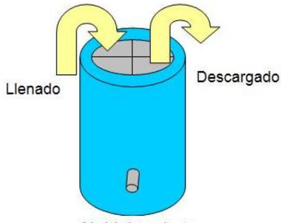
Figura 1.2 Esquema de un biodigestor de régimen estacionario. (Torre Guillén D., 2009)
