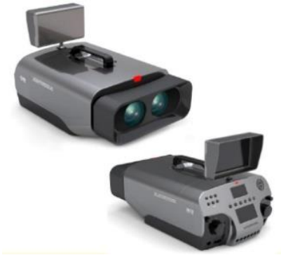
Figura 2.4.1. Cámara binocular para capturar imágenes ortoestereoscópicas.
