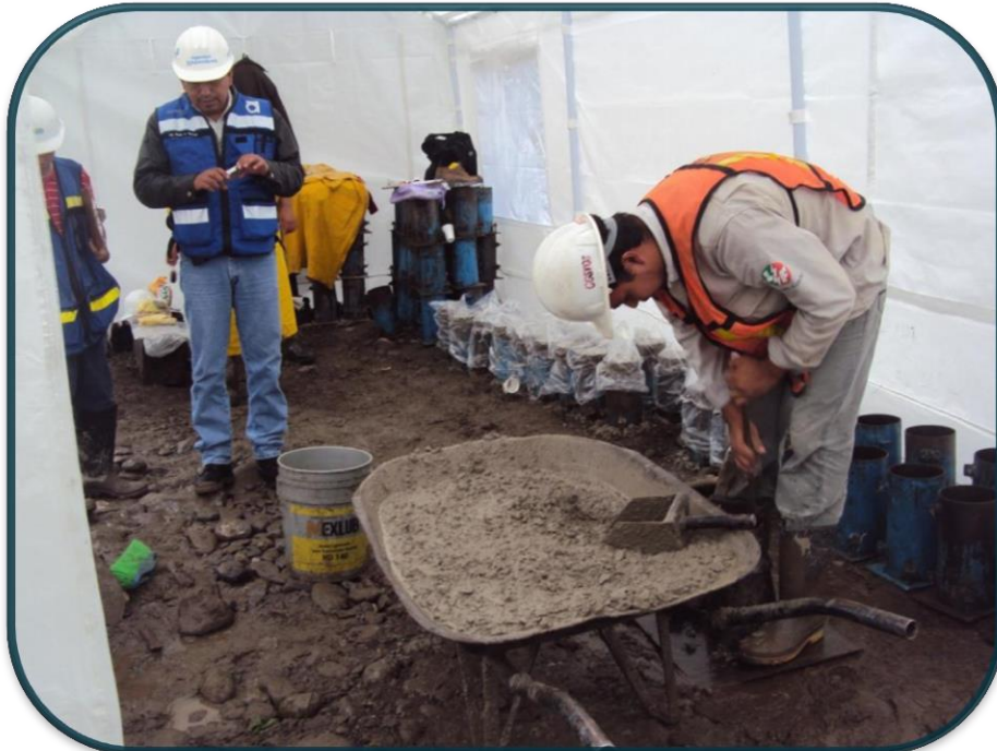
FOTOGRAFIA No.78.-Las pruebas de laboratorio que se realizaba eran las comunes pero se hacían aleatorias como lo especifica la norma cada 10 ollas en su caso.
