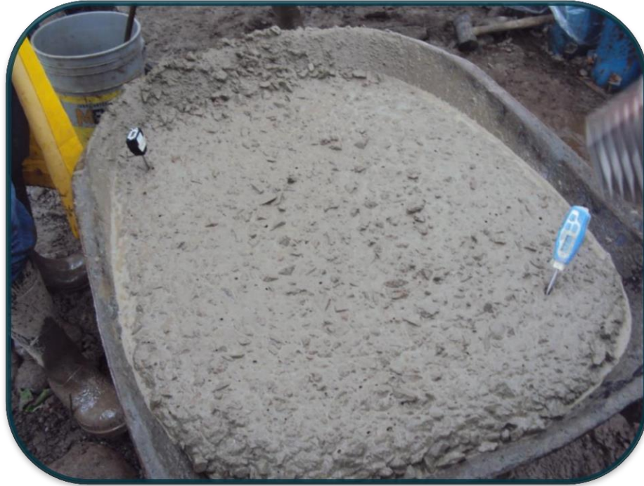
FOTOGRAFIA No.79.-A las pruebas de laboratorio comunes se le agrego la medición de temperatura en frio, ya que el hielo permitió que el concreto estuviera dormido.
