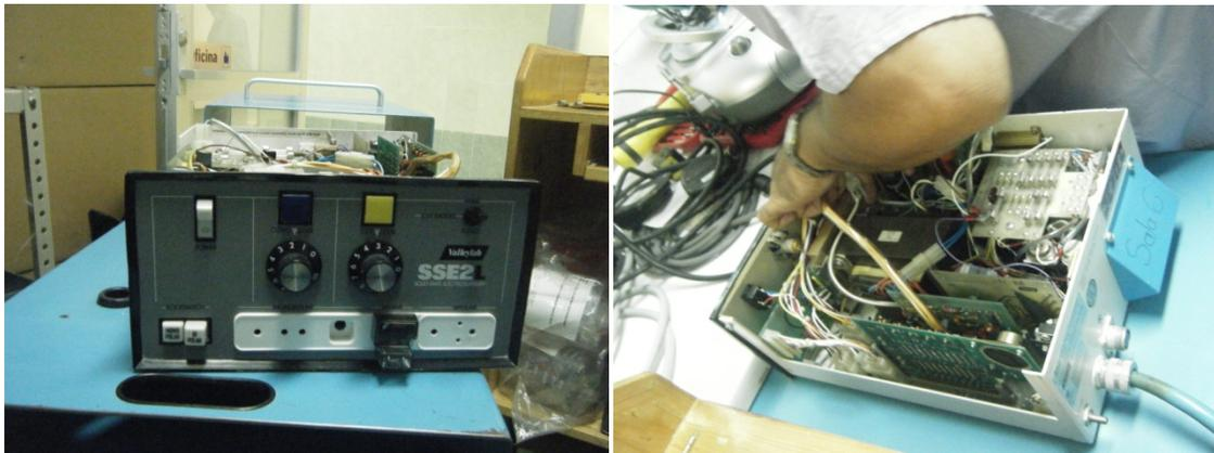
Se les realiza el cambio de fusibles y transistores ya que con frecuencia son los componentes que causan problemas en el equipo.
