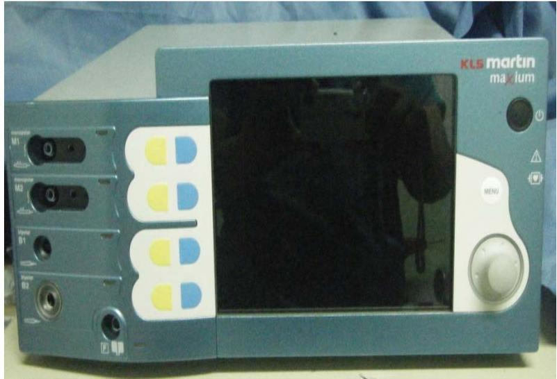
En el equipo no debe penetrar ningún líquido, el equipo no debe esterilizarse. Antes de poner en funcionamiento el equipo, hay que eliminar totalmente los restos de los productos de desinfección.
