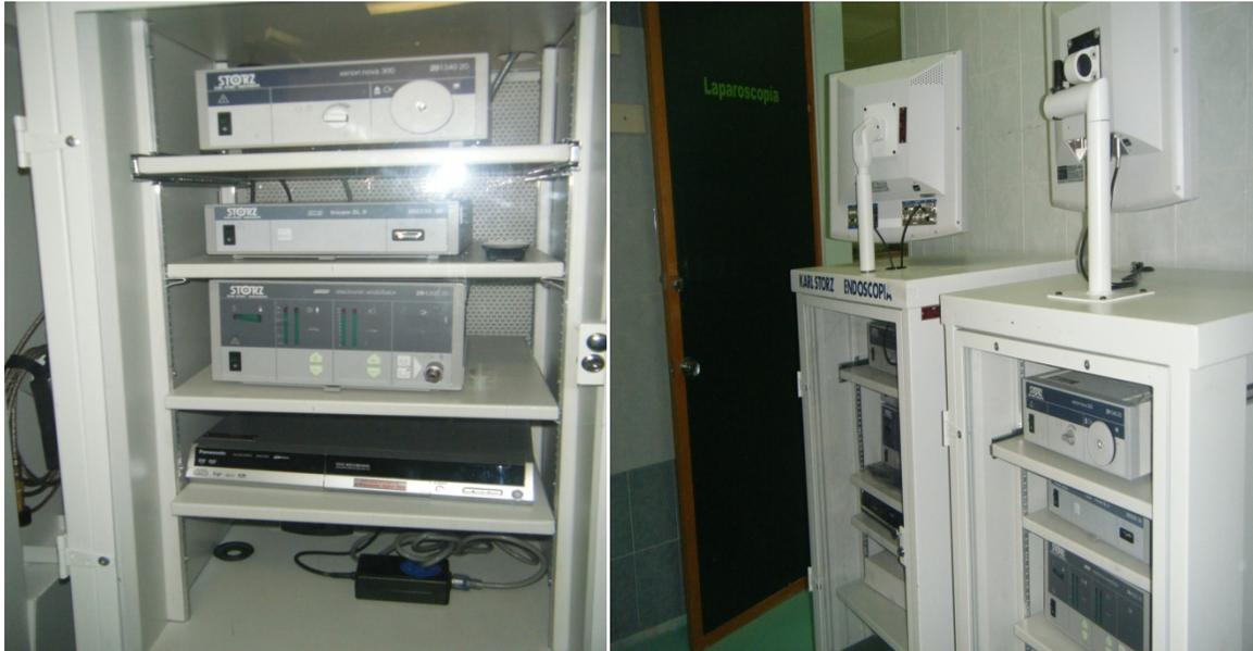
En específico a la fuente de luz fría se le realiza el cambio de los focos de xenón, esto se debe a que cada foco tiene una vida útil de 500 horas y se va midiendo por un contador con el cuenta la unidad, al estar a punto de llegar a terminar su vida útil, el led rojo de la parte posterior de la unidad se prende, este es el indicativo para reemplazar el foco.
