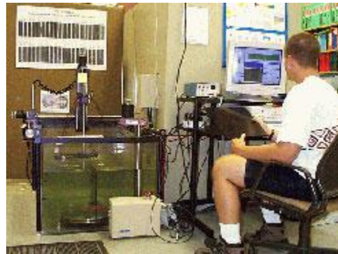
Figura 2.6 Ejemplo Transductores de inmersión
