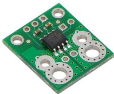
Fig 2.2: Sensor de corriente de efecto Hall ACS714 en placa Phidgets.
