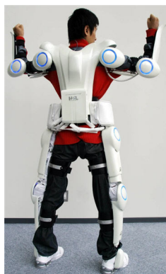
Fig. 1.4: Vista trasera de exoesqueleto HAL. Los motores de las articulaciones están dentro de los círculos azules, la batería es la caja rectangular en la espalda baja.
