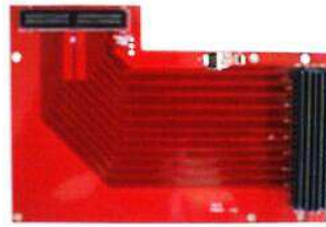
Figura 2.11 Adaptador FMC empleado para conectar el módulo de acondicionamiento analógico conversión A/D al módulo de almacenamiento y transmisión.
