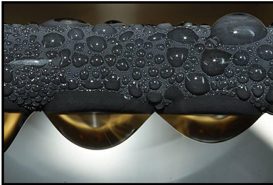
Figura 2. 5 Condensación por goteo. 29
