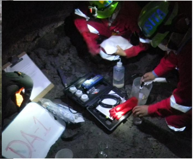
Figura 5-5 Medición de pH "in situ" con potenciómetro
