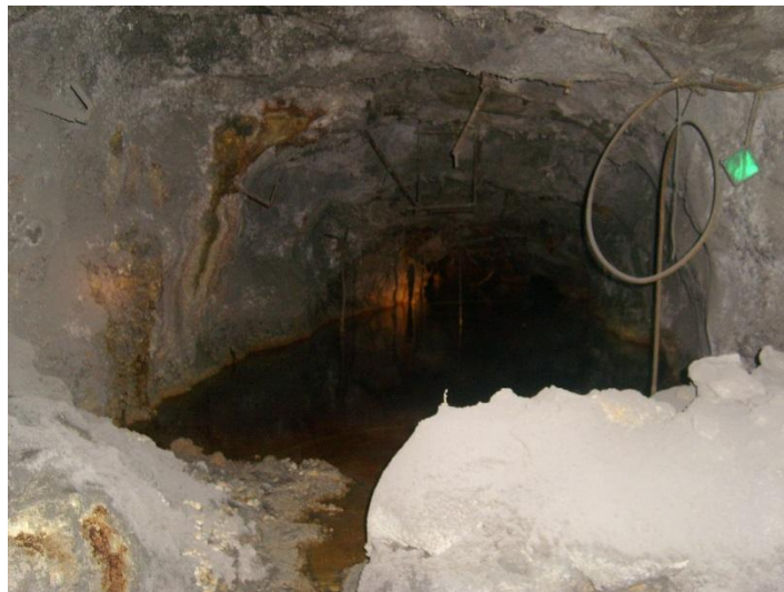
Figura 5-6 Rebaje con presencia de DAM
