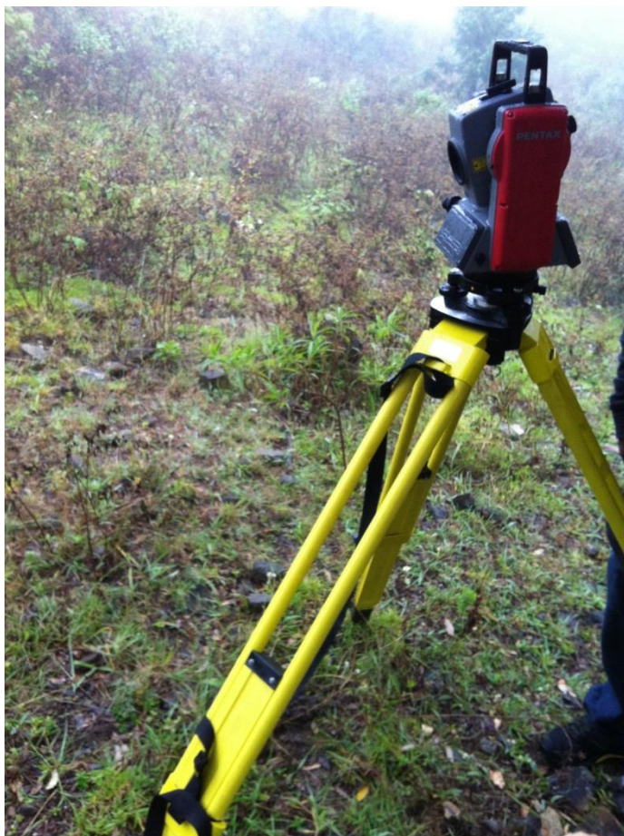
Figura 9-7 Estación Total en Cuarto Reconocimiento
