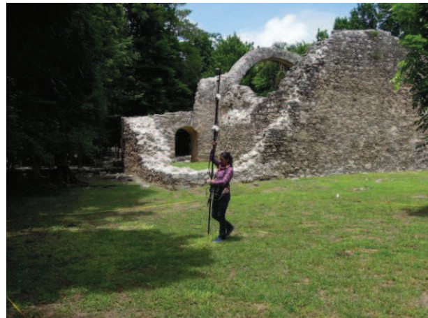
Figura. 3.1.37. Estación magnética de repetición Chetumal 2013, Levantamiento Magnetométrico con el Magnetómetro OVERHAUSER GSM-19. (3-sep-2013)
