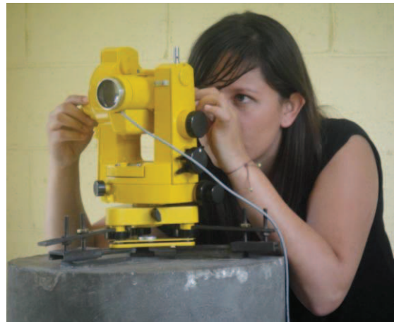
Figura. 3.1.29. Teodolito DI-FLUX ZEISS A-20 con el círculo en dirección al Norte y el sensor Fluxgate con dirección hacia-abajo.
