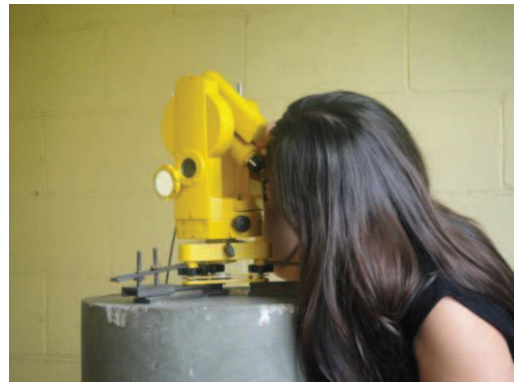
Figura. 3.1.32. Teodolito DI-FLUX ZEISS A-20 con el círculo en dirección al Oeste y el sensor Fluxgate con dirección hacia-arriba.
