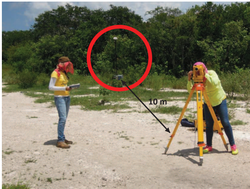
Figura. 3.1.22. Estación Magnética de Repetición de Mérida 2013, utilizando el Magnetómetro OVERHAUSER GSM-19 como estación base.
