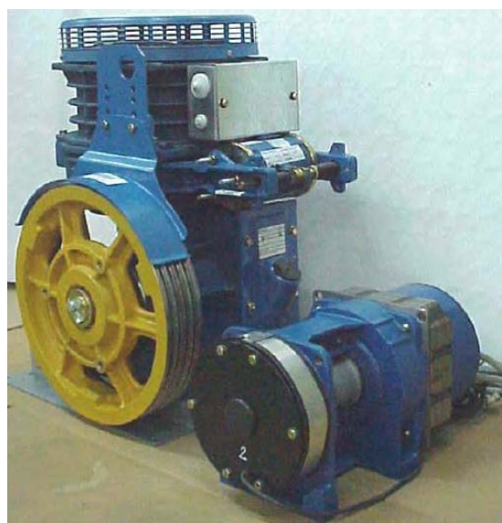
Figura 2.20 A la izquierda maquina convencional a la derecha máquina de última generación
