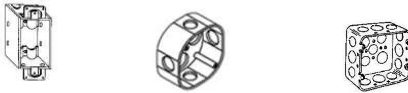
Fig. 16. Tipos de cajas metálicas.
