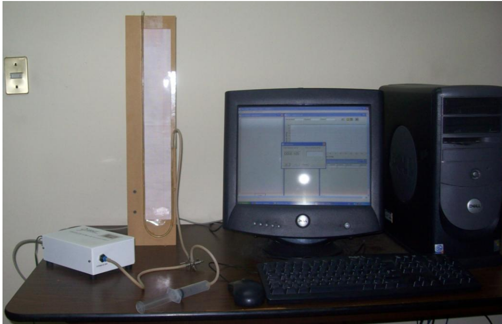
Figura 34. Fotografía del montaje para pruebas de calibración al MMRS
