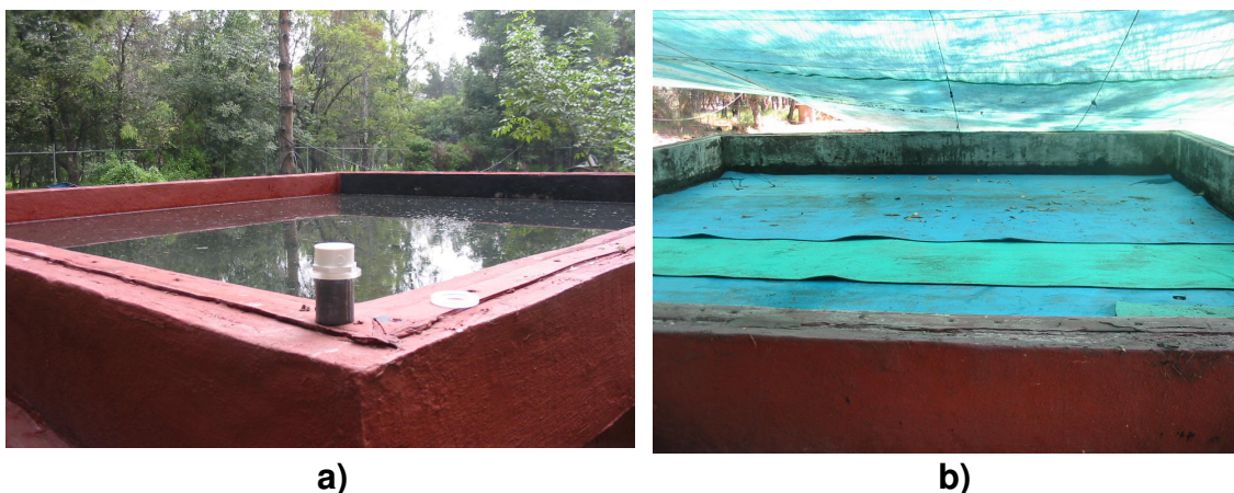
6.22 Vista del reactor al inicio de la investigación de natas, a) Fase descubierta; b) Fase cubierta.
