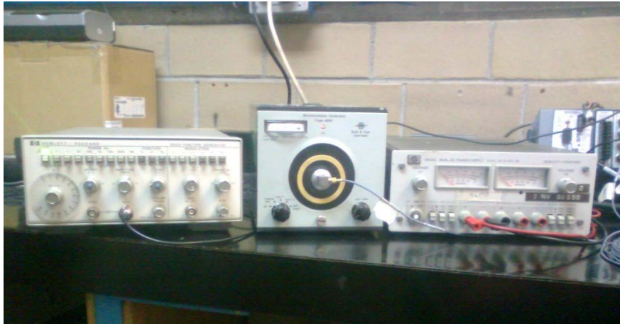
Figura 5.1 Generador de funciones, calibrador de acelerómetros y fuente de tensión.
