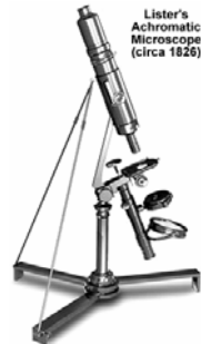
Figura 1.6. Microscopio acromático de Lister [4]
