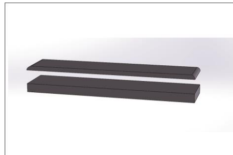
Corte que se hace en sierra cinta Fig.4.2.D
