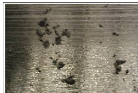
Defecto: Inclusión de escoria Fig.1.3.C Cortesía MAHLE Componentes de Motor de México
