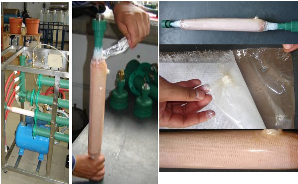
Figura 4.6. Ruptura de la membrana de los cartuchos
