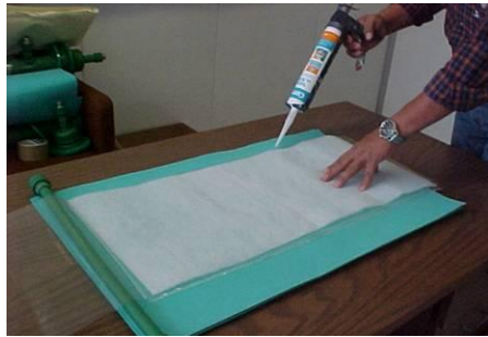
1. Colocación de cordones pegamento en los laterales de la membrana inferior.
