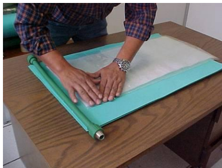
3. Sellado de los extremos aplicando presión.
