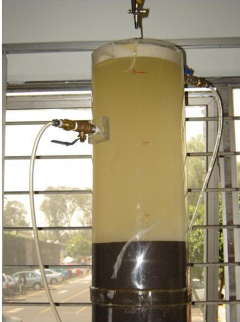
Figura 3.26. Retrolavado del filtro
