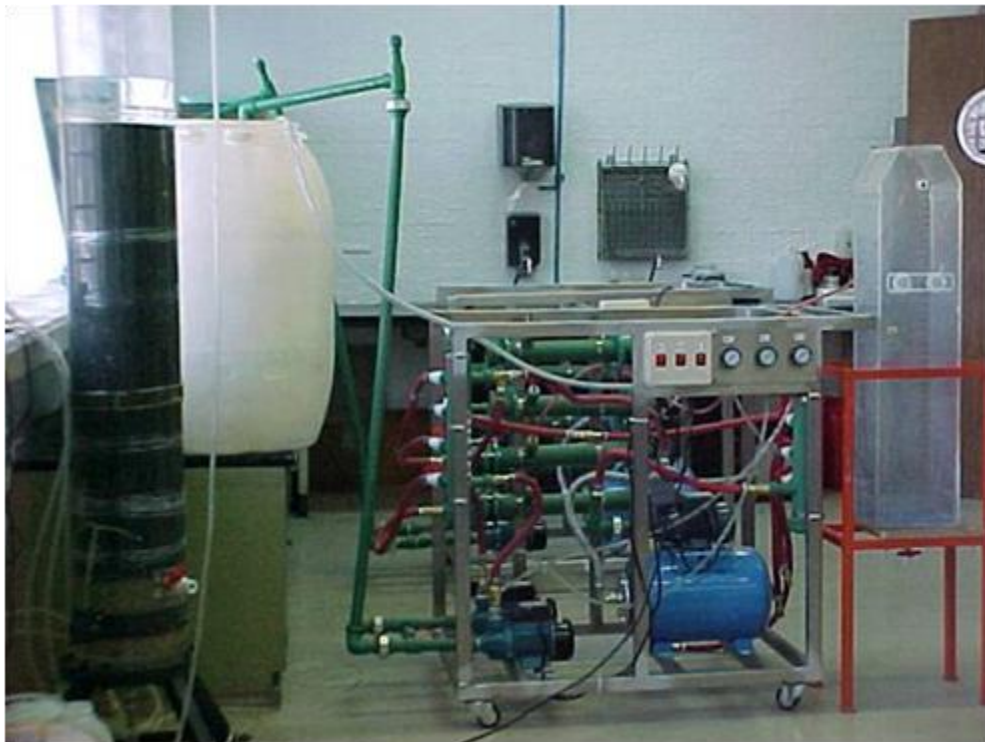
Figura 3.4. Sistema de ultrafiltración y filtro de arena
