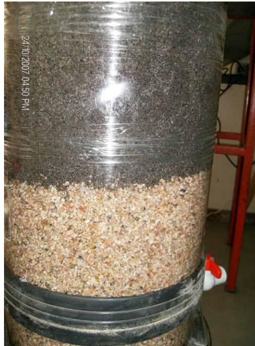
Figura 3.22. Capa de grava y arena del filtro.
