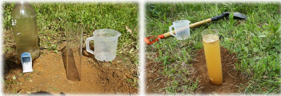
Figura no. V-6 Prueba sencilla de percolación en campo
