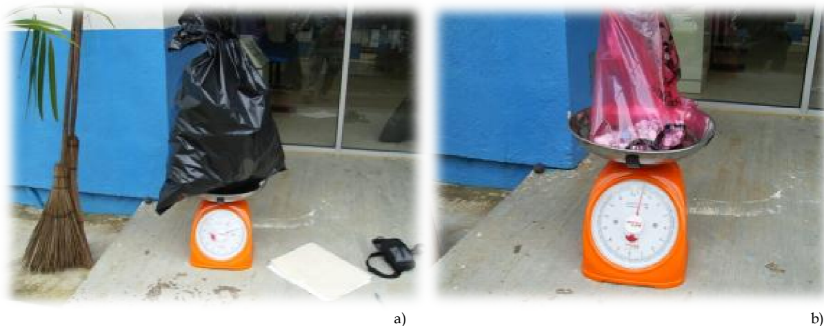
Figura no. IV-8 Pesaje de residuos generados en el centro de salud rural. a) Pesaje de residuos sólidos urbanos; b) pesaje de residuos peligrosos
