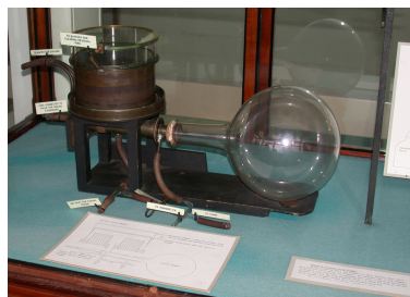
Figura 2.5: Cámara de niebla de Wilson en el museo del Laboratorio Cavendish, en la universidad de Cambridge.
