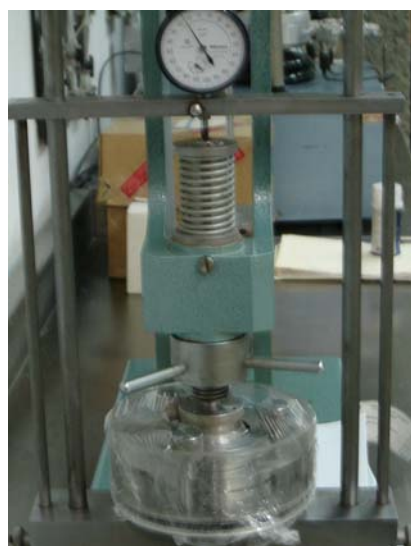
Fig. 5.9 Puente de medida y micrometro
