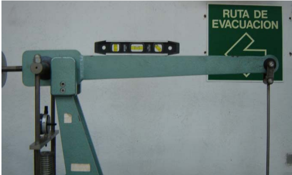
Fig. 5.14 Nivelación del marco de carga
