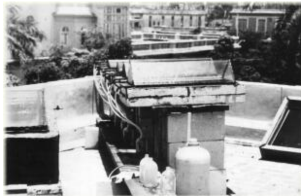
Figura 1.5 Destiladores solares de caseta en una azotea de La Habana Vieja. [XIII].
