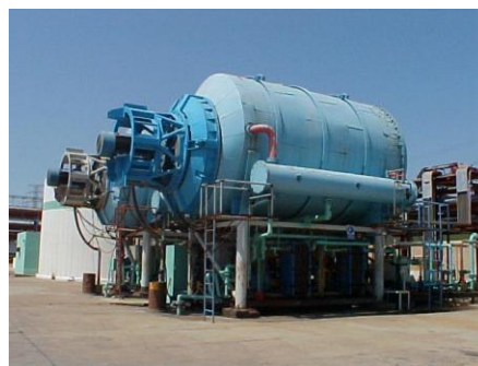
Figura 1.10 Planta desalinizadora por CV. Introducción a la Desalación. Curso impartido en el Instituto de Ingeniería de la UNAM, 28 de mayo del 2007 por José Antonio San Juan, Presidente de IDA.
