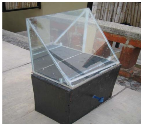
Figura 1.6 Uno de los diferentes destiladores solares caseros utilizado en México.
