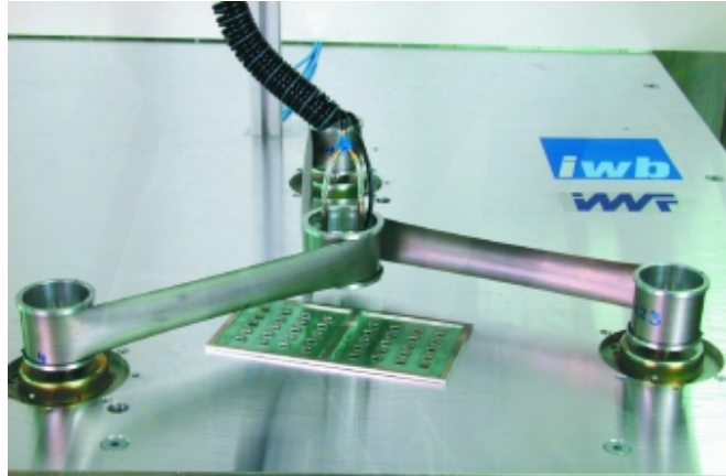
Figura 1.1: Dispositivo de manipulación de alta precisión - Esta máquina está equipada con un sistema de control altamente dinámico que compensa todas las perturbaciones que afectan a la precisión dentro del intervalo de 1 micra.
