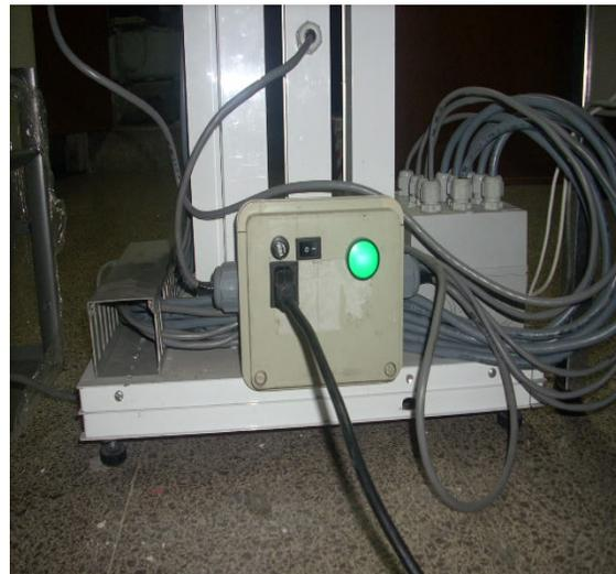
Fotografía 4. Muestra parte trasera inferior (caja para alimentación eléctrica de el electro manes).
