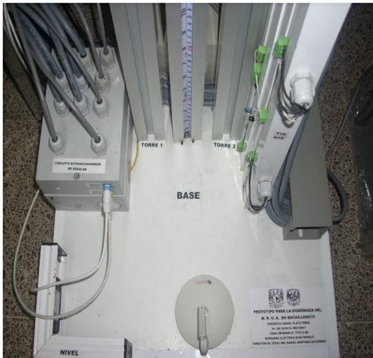
Fotografía 3. Muestra elementos de la base (micrófono, nivel y caja para el electrónica).
