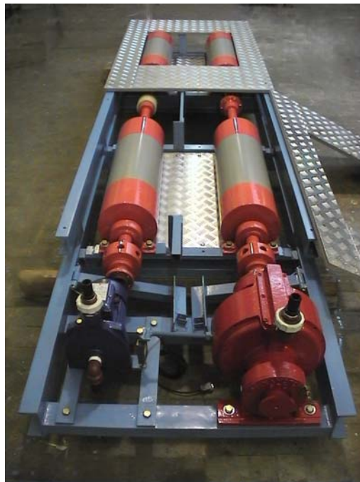
Figura 3.2. Dinamómetro de chasis: Dinamotor (4 rodillos, freno hidráulico) .
