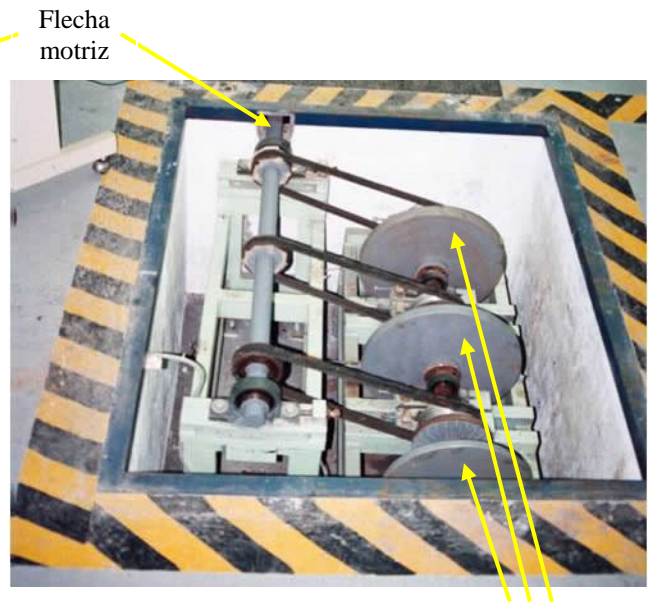
Fotografía 3.1.4. Acoplamiento de los volantes de inercia.
