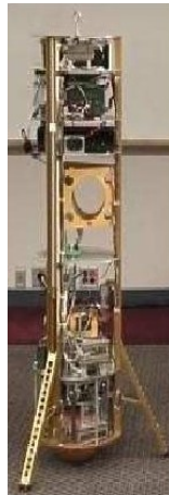
Figura 2.4: Ballbot con patas de soporte para equilibrio estático.
