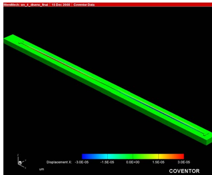
Figura 5.12.a. Desplazamientos en X para una aceleración de 50g en dirección Y.
