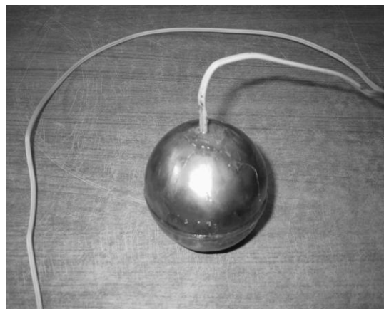
Figura 10. Cascarón esférico de acero inoxidable de 0.065 \text{ m} de diámetro, relleno del material de construcción a evaluar.
