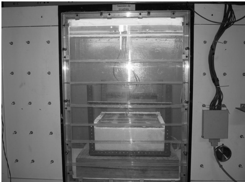
Figura 21. Vista del prototipo de pruebas con el muro de ladrillo rojo, dentro de la sección de pruebas del Túnel de Viento.
