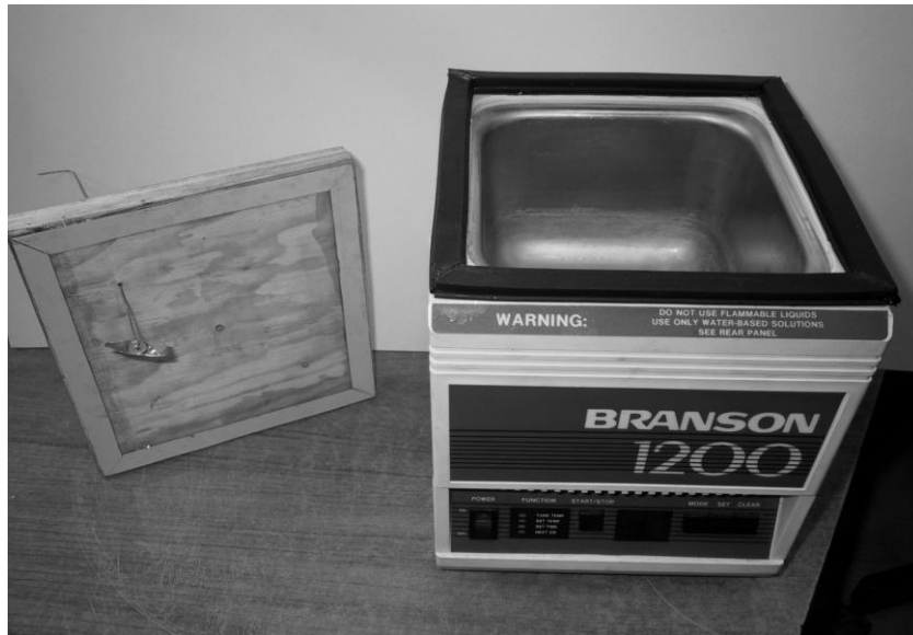
Figura 9. Vista del calorímetro con su nueva tapa, usado para la determinación del calor específico de materiales de construcción.
