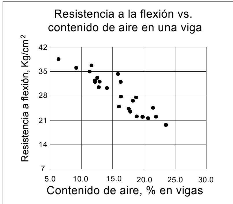
Fig. 4.4- Relación entre el contenido de aire y la resistencia a flexión para el concreto permeable ( 1 \text{ psi} = 0.006895 \text{ MPa} ).
