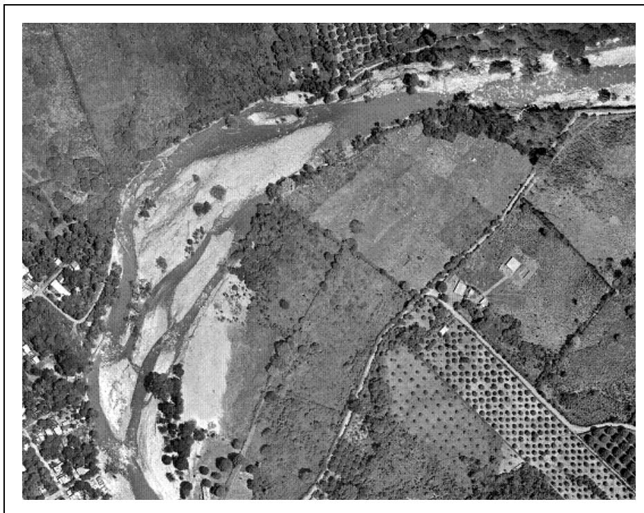
Figura 4.2 Ejemplo de cauce trezado (Fotografía aérea del río Huehuetán, 2005).
